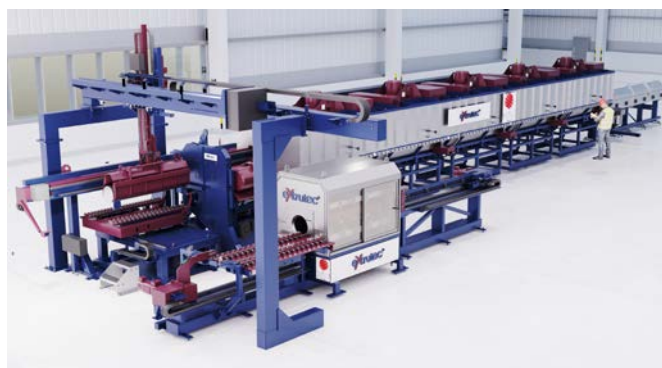
Bild 2: EHKO im Betrieb als „In-Line“- (links) und Offline-Version (rechts) mit integrierter Energy Saving Unit (ESU) (Quelle: extrutec)
